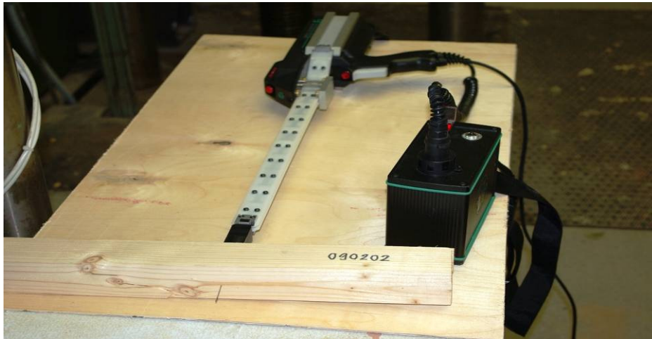
Joonis 2. Resistograaf - mudel SIBERT Digital microprobe.
