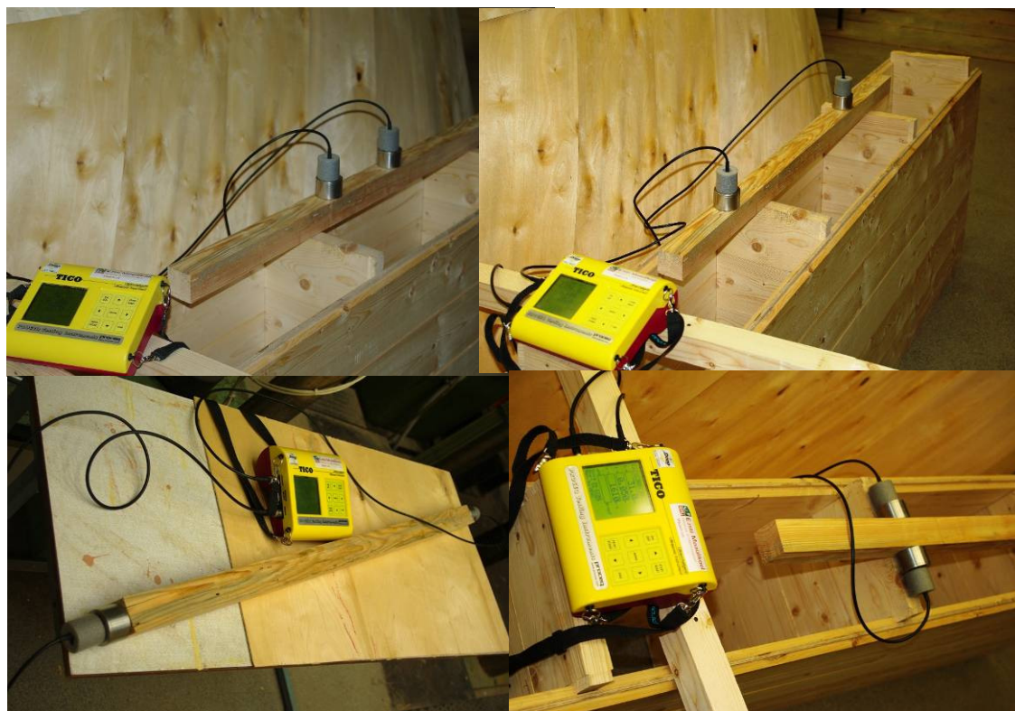
Joonis 7. Ultraheli mõõtmisaparaadiga mõõtmine pikikiudu ja ristikiudu
