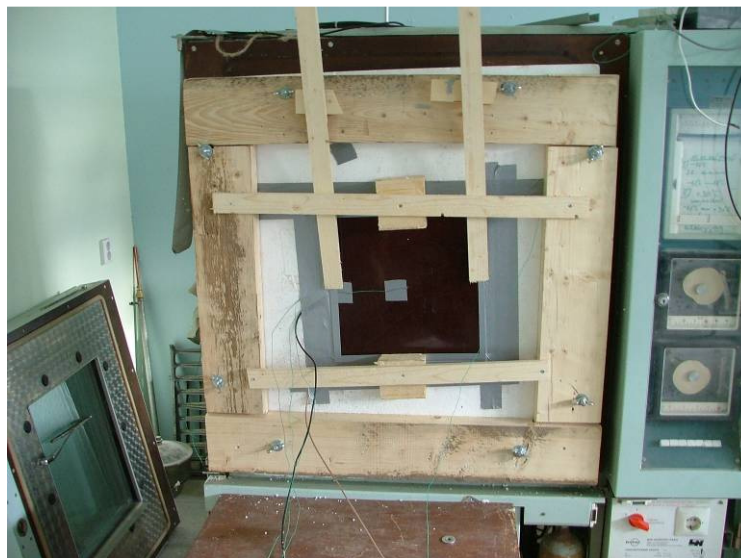
Joonis 3. Kliimaseade Feutron 3007-5 koos katseseinaelemendiga, mis on mõeldud soojuseri juhtivuse määramiseks koos vastavate mõõteanduritega
