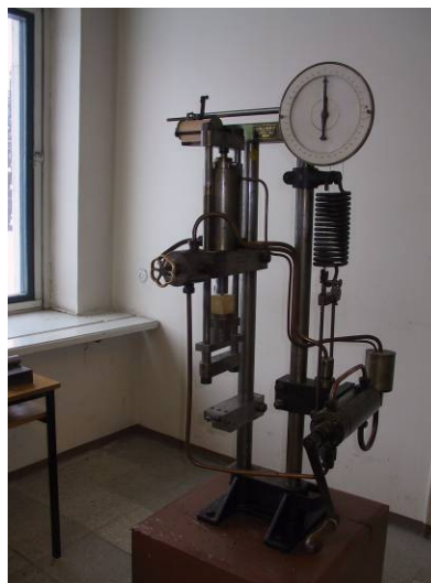
Joonis 6. Universaalne katseseade Amsler
