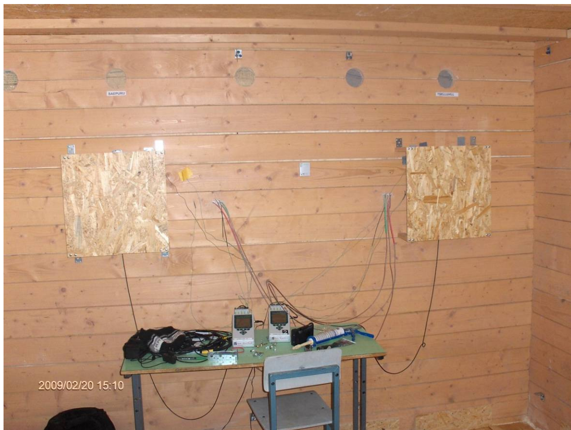
Joonis 6. Statsionaarse katse mõõtmise komplekt saepuru ja tselluvilla soojusjuhtivuse uurimiseks
